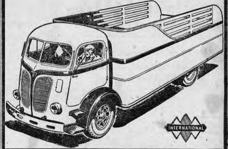
Arriba: He aquí una primera vista del nuevo Camión Internacional para trabajo pesado, con Caseta sobre el Motor. Observe la corta distancia entre ejes, el amplio espacio para la carga y la espaciosa caseta.
